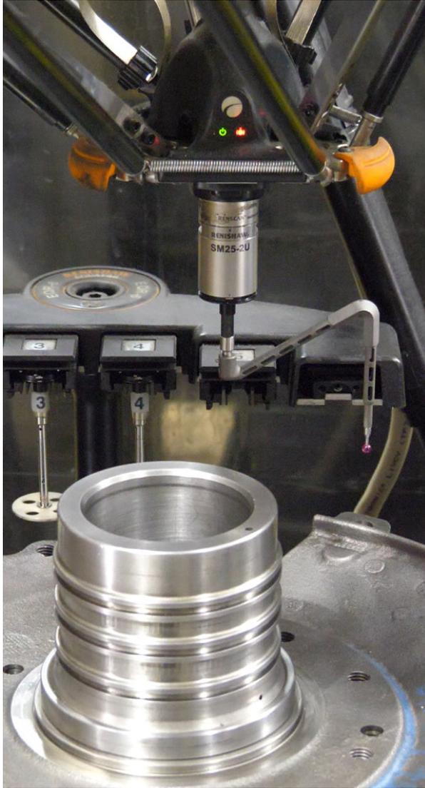
Inspection d'un composant automobile sur Equator 300 avec un stylet issu de la fabrication additive
