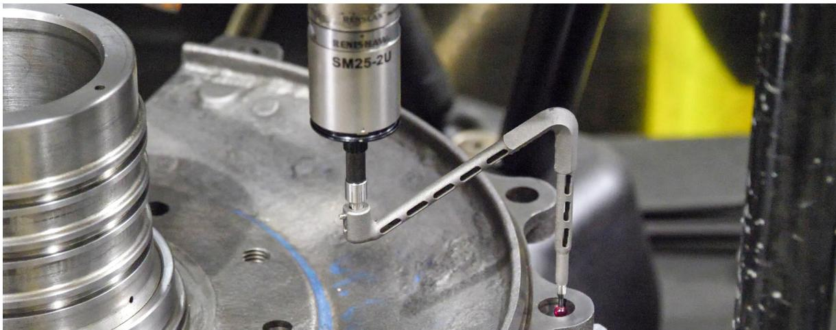
Stylet sur mesure obtenu par impression 3D métallique sur un système RenAM 500Q
