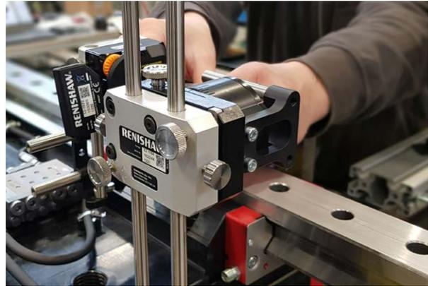
Alignement du pentaprisme du système d'alignement XK10 pour effectuer un test de parallélisme
