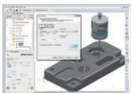
**Dimensionnements et tolérances (GD&T) :** création d'éléments pour déterminer les relations entre entités en vue d'une comparaison complète des mesures machine par rapport aux schémas de fabrication avant enlèvement des composants.
