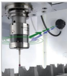
**Transmission optique modulée** - elle est intégrée à tous les palpeurs de nouvelle génération OMP, offre une résistance optimale aux interférences lumineuses.
