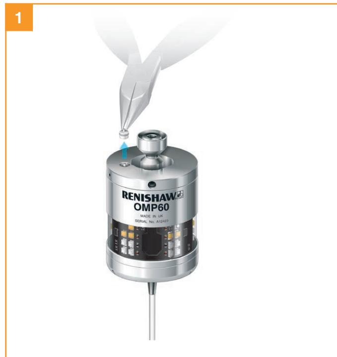
**REMARQUE :** Dans les cas où l'OMP60 doit être utilisé avec un contacteur sur cône, il faudra retirer le bouchon de l'arrière du palpeur avec une pince. Il faudra alors le remplacer par la bobine (A-4038-0303).
