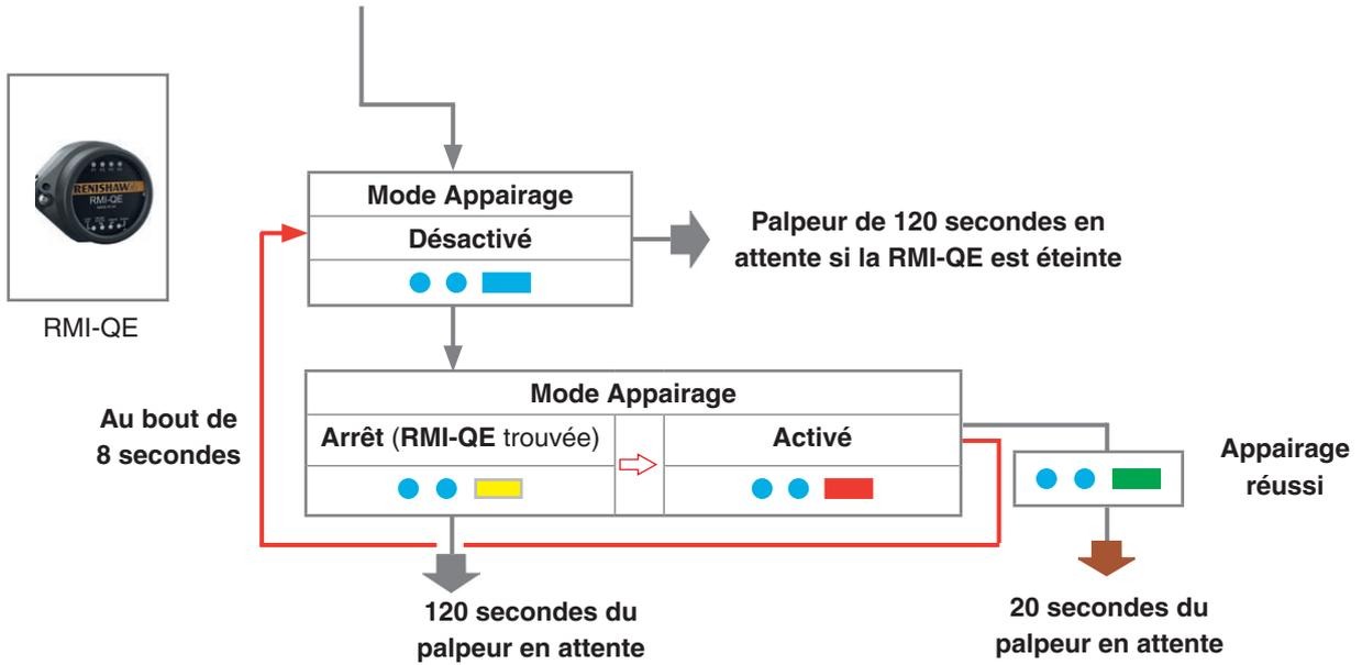
Si l'appairage n'est pas réussie, « **Mode Appairage désactivé** » s'affiche à nouveau au bout de 8 secondes. Lorsque « **Mode Appairage désactivé (RMI-QE trouvée)** » est affiché, défléchissez le stylet pendant moins de 4 secondes pour sélectionner à nouveau « **Mode Appairage activé** ».
