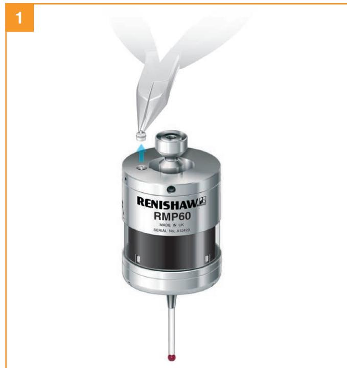
**REMARQUE :** Dans les cas où le RMP60 doit être utilisé avec un contacteur sur cône, il faudra retirer le bouchon de l'arrière du palpeur avec une pince. Il faudra alors le remplacer par la bobine (A-4038-0303).
