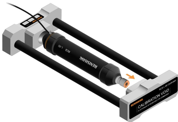
3. Pour le retrait, inversez la procédure. Fermez l'appareil en rétractant l'extrémité non câblée, avant de le retirer de l'étalon.
