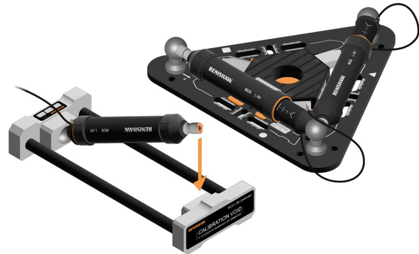
2. Allonger l'instrument de sorte que l'extrémité opposée de l'instrument atteigne la surface de la bille opposée de l'étalon. Assurez-vous que l'instrument RCS L-90 est fixé magnétiquement à l'étalon.
