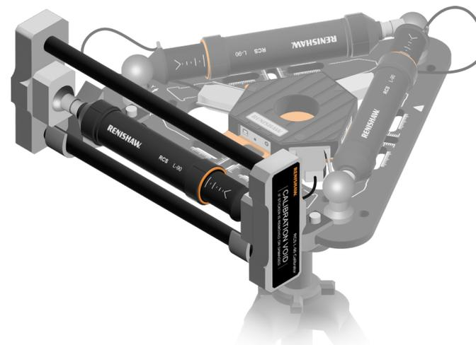
5. L'étalon doit être incliné vers la plaque de base. Les supports comportent une butée mécanique sur laquelle l'étalon doit venir s'appuyer. Ainsi, il ne basculera pas en arrière.
