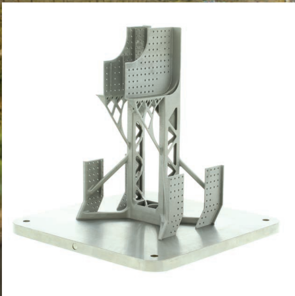
Support Central en Titane (CTS) pour le projet ARION4 mené par la Vélocipède Team de l'université de Liverpool (ULV Team), dans le cadre duquel Karen Darke et Ken Talbot ont établi des records de vitesse avec des vélos à mains lors du World Human Powered Speed Challenge à Battle Mountain, dans le Nevada, aux États-Unis.
