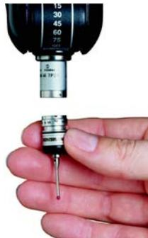
*Les spécifications et la configuration du stylet risquent d'affecter la précision des résultats des mesures*
