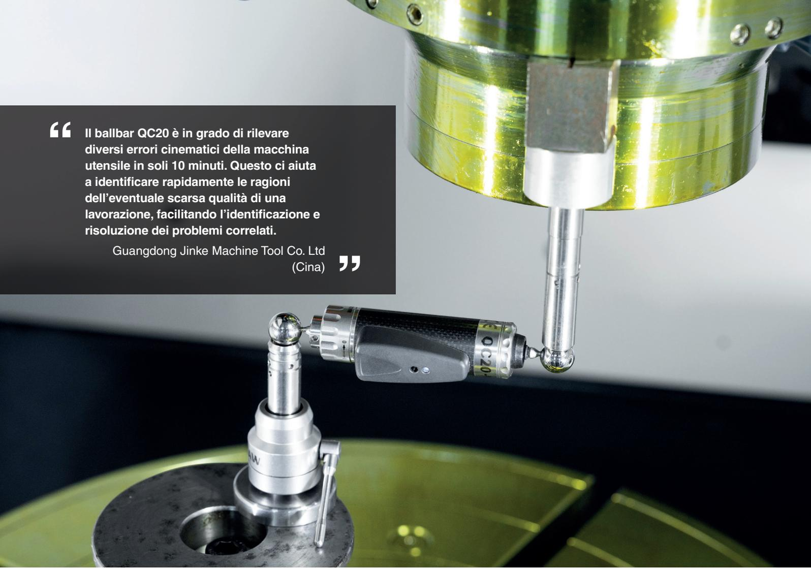
“ Il ballbar QC20 identifica rapidamente i problemi, senza dover smontare la macchina per capire se c'è qualcosa che non va.
