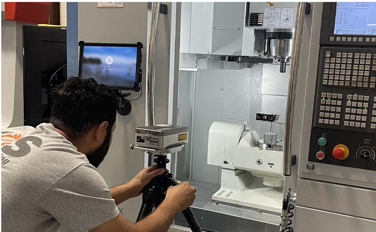
Sistema laser XL-80 di Renishaw su una macchina utensile CNC
