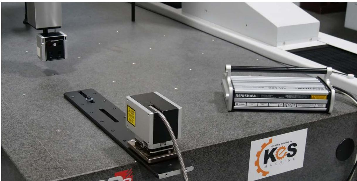
Sistema di calibrazione multiasse XM-600 di Renishaw su una CMM
