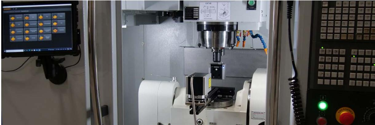
KES si avvale dell'XM-60 sia sulle macchine utensili CNC che sulle CMM per operazioni di compensazione volumetrica
