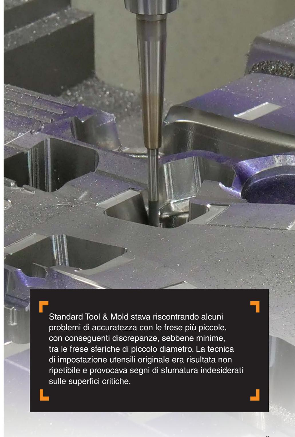
Standard Tool & Mold stava riscontrando alcuni problemi di accuratezza con le frese più piccole, con conseguenti discrepanze, sebbene minime, tra le frese sferiche di piccolo diametro. La tecnica di impostazione utensili originale era risultata non ripetibile e provocava segni di sfumatura indesiderati sulle superfici critiche.
