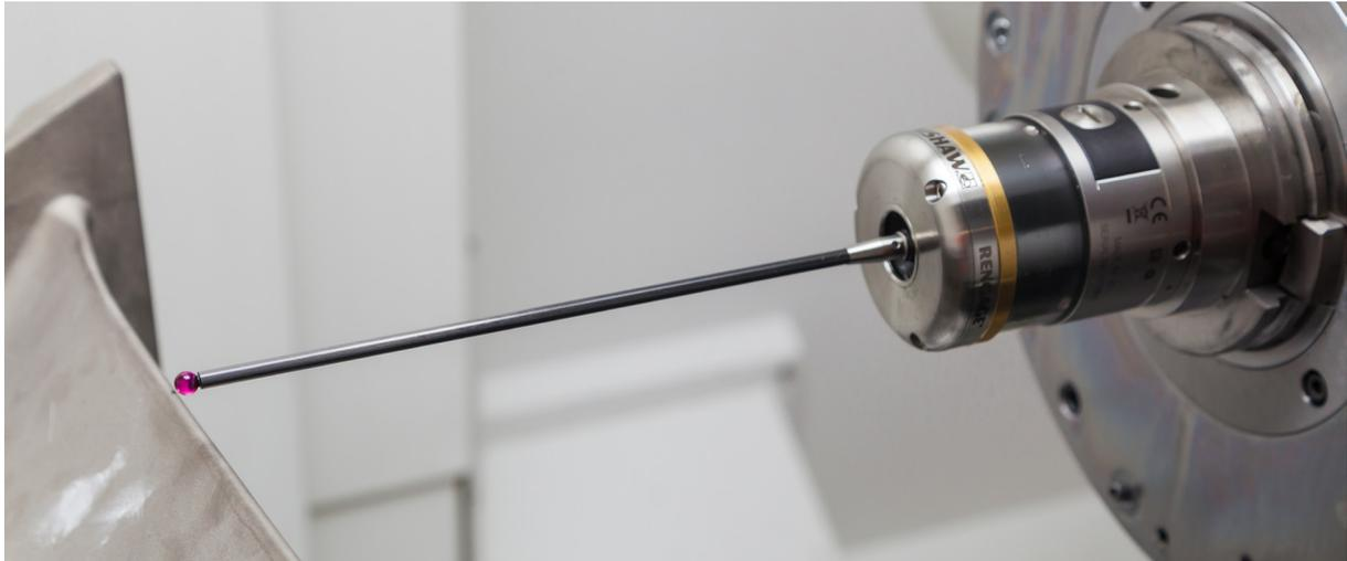
Una sonda RMP600 rileva la posizione di una superficie aerodinamica
