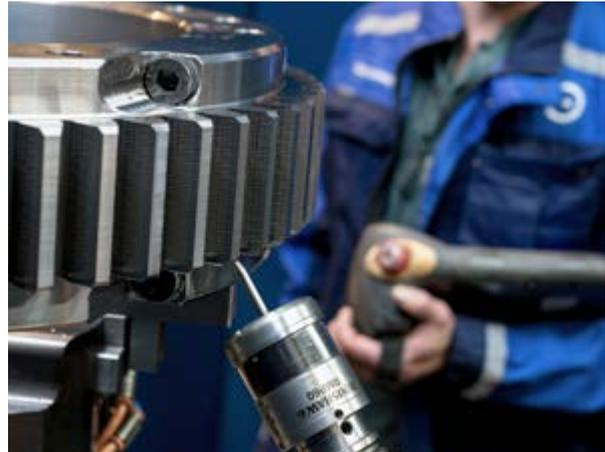
Sonda Renishaw RMP60 mentre controlla le dimensioni finite dell'ingranaggio dopo la sbavatura
