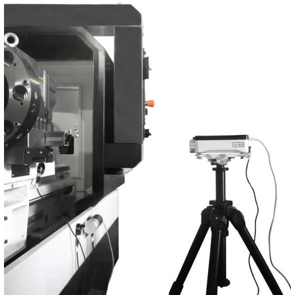
Verifica dell'accuratezza dei movimenti delle macchine utensili con il sistema laser XL-80
