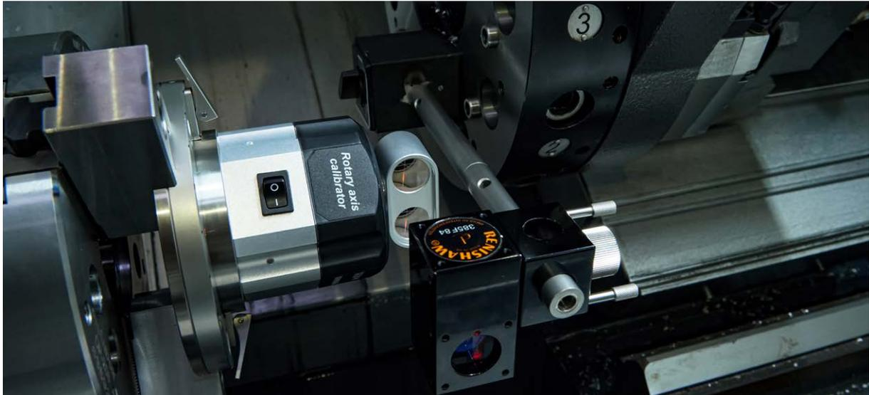
Calibrazione in macchina con il sistema di calibrazione XR20-W per assi rotanti
