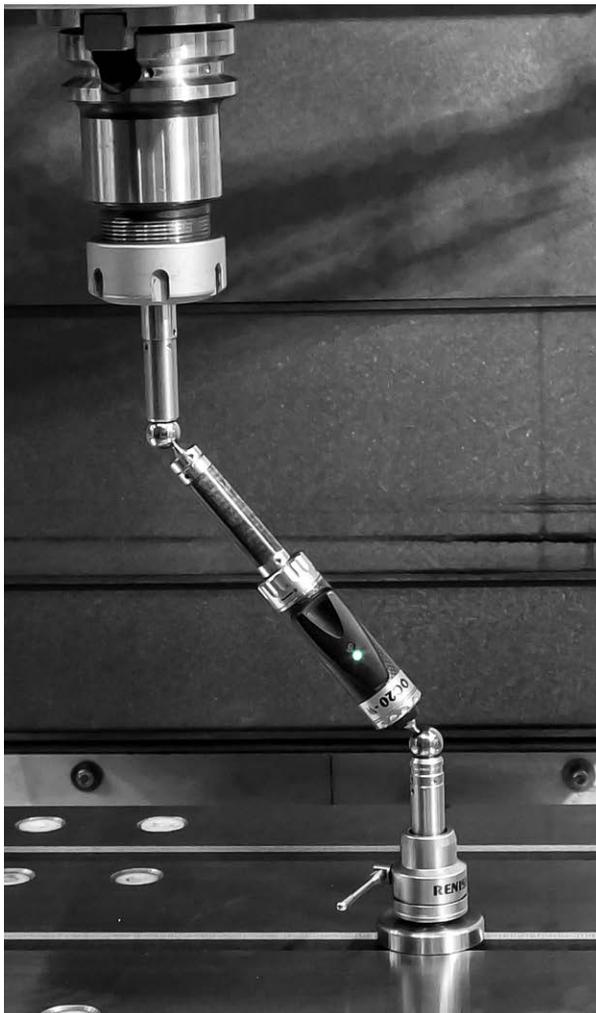
StankoMachComplex usa un ballbar QC20-W per monitorare le condizioni della macchina utensile
