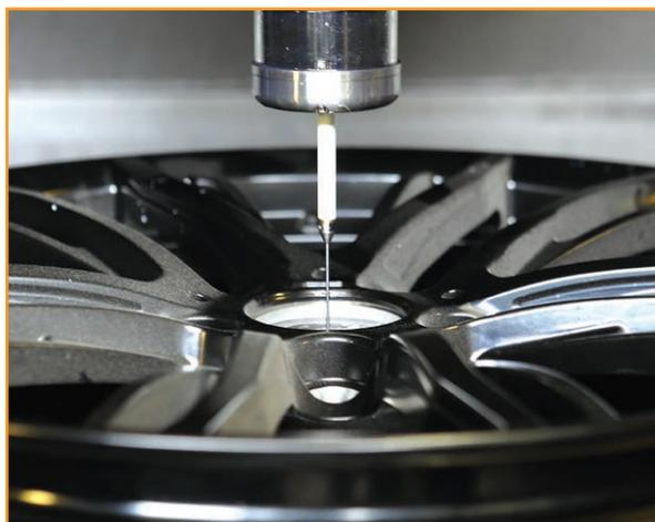
Sonda RMP60 mentre misura la superficie di montaggio del cerchio in lega
