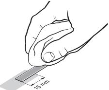
Mescolare bene i due componenti dell'adesivo epossidico RGG-2 e applicare una piccola quantità di miscela sul lato inferiore del fissaggio di estremità.
