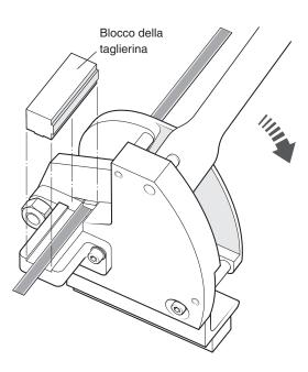
Tenere il blocco in posizione e abbassare la leva con un movimento fluido, per tagliare la riga fino in fondo.
