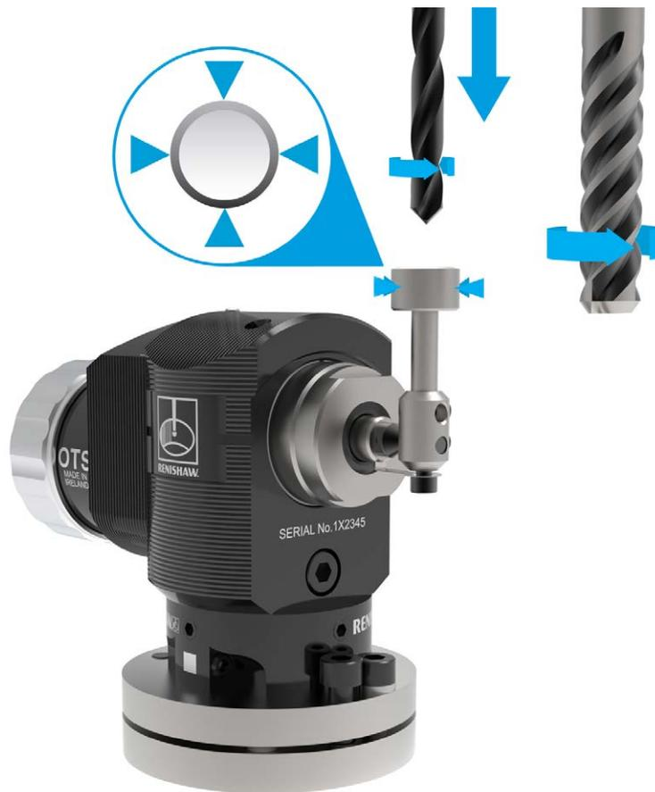
L'utensile viene posizionato sull'asse Z della macchina per la misura della lunghezza e la verifica dell'integrità.
