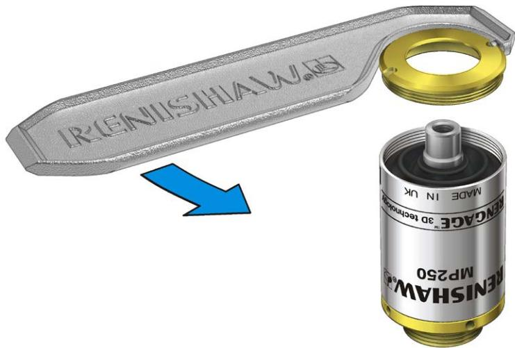
3. Pulire il diaframma esterno e controllare se è danneggiato. Se si rilevano danni, sostituire il diaframma esterno. Ordinare il kit per la sostituzione del diaframma (codice Renishaw n. A-5500-1650).
