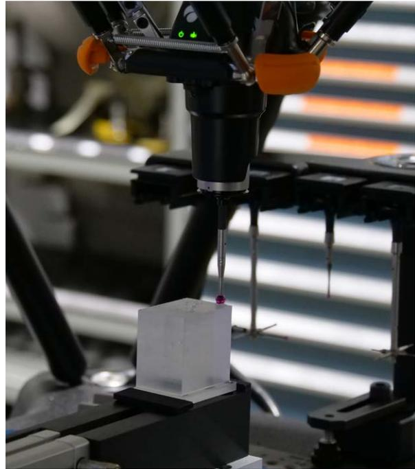
Componente di precisione a cuneo sottoposto a ispezione sul sistema di ispezione Equator
