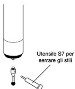
Per installare uno stilo in una sonda a contatto Renishaw, inserire nel supporto uno stilo con la filettatura corretta oppure utilizzare un adattatore e serrare con l'utensile S7 fornito in dotazione. Se lo stilo viene serrato con utensili diversi da quello in dotazione (chiavi, avvitatori o altro), il meccanismo della sonda potrebbe subire danni.
