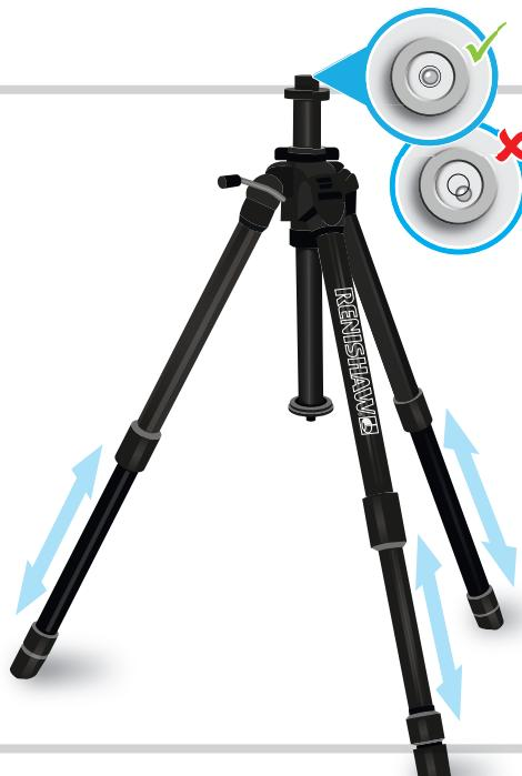
**NOTA:** il treppiede va utilizzato solo quando non è possibile fissare l'emettitore alla struttura della macchina. L'emettitore rappresenta il riferimento e, pertanto, qualsiasi instabilità del treppiede potrebbe compromettere l'accuratezza dei test.
