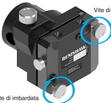
Le viti di beccheggio e imbardata servono ad allineare le ottiche pentaprismatiche parallelamente all'emettitore e alla guida di misura.
