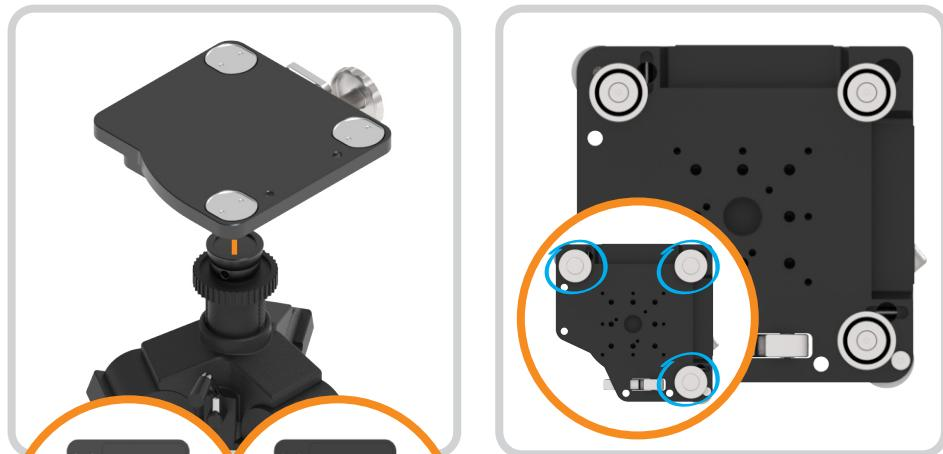
Usare la leva per fissare la base di traslazione all'adattatore per treppiede.
