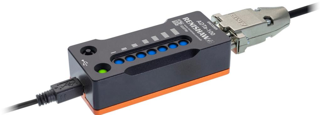
ADTa-100 (A-6525-0100) è un accessorio per impostazione e diagnostica, sviluppato appositamente per gli encoder assoluti Renishaw. Consente anche la scrittura di una nuova posizione di zero <sup>1</sup>.
