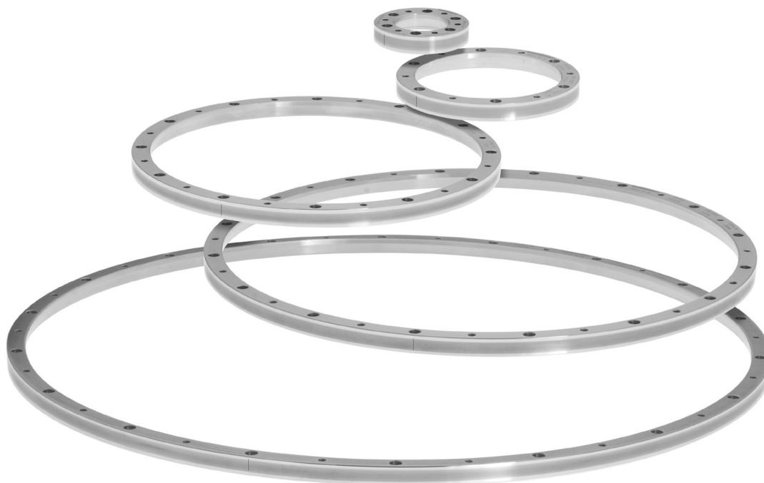
**L'anello RESM è realizzato con un unico pezzo di acciaio inossidabile, ha una graduazione da 20 o 40  $\mu\text{m}$  incisa sul bordo esterno e zero ottico a fasatura automatica *IN-TRAC*™ integrato.**
