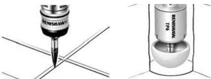
Gli stili a sfera concava in ceramica sono ideali per ispezionare elementi e fori molto profondi nelle direzioni X, Y e Z e richiedono l'impostazione del riferimento di un'unica sfera. La serie include due versioni: con diametro da 18 e 30 mm, sviluppate appositamente per le sonde TP2 / TP20 / TP200 e per TP6. Una sfera dal diametro ampio può ridurre gli inconvenienti derivanti da superfici di ispezione particolarmente rugose.
