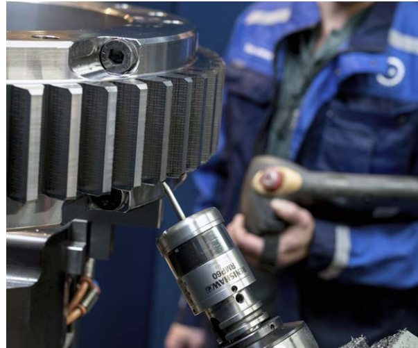
バリ取り後のギヤの寸法を確認する RMP60 プローブ
