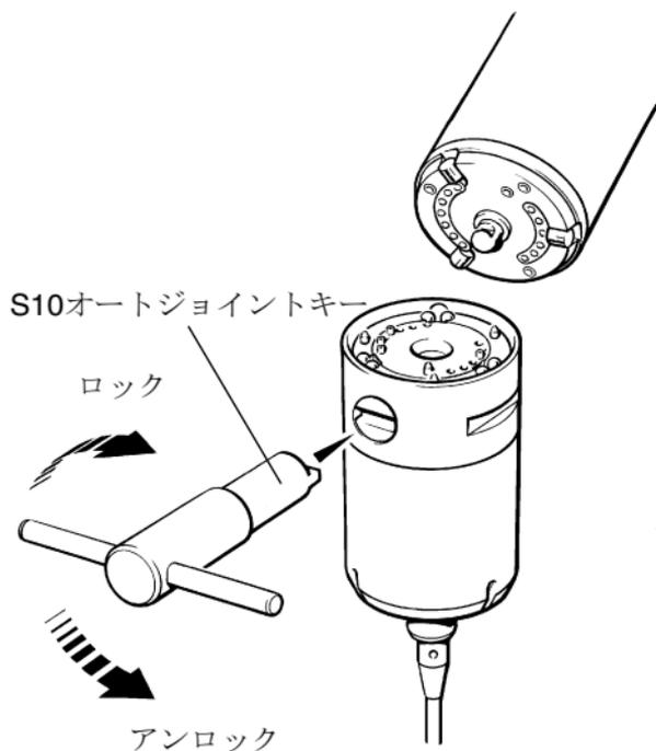
図21 オートジョイント式タッチトリガープローブの
