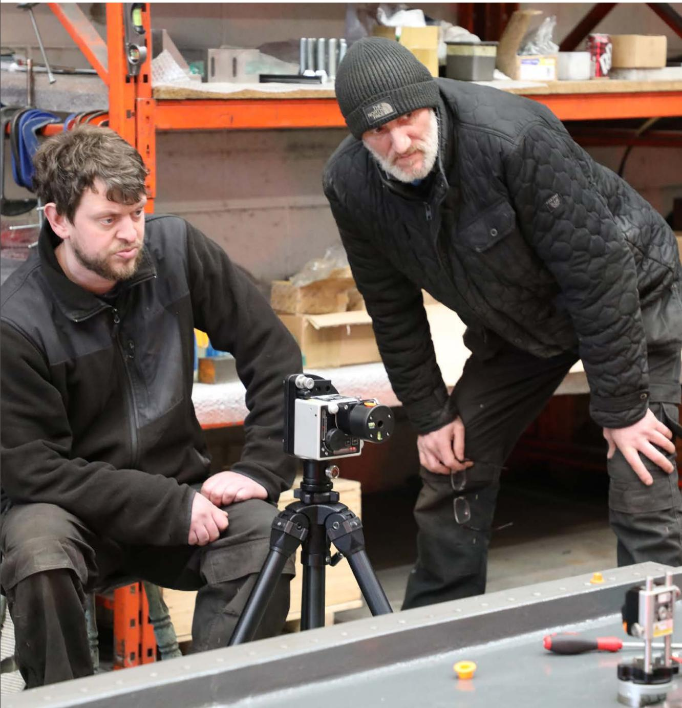
XK10 レーザー アライメントシステムは、HNC 社の機械キャリブレーションプロセスの効率化で大きな役割を果たした。「XK10 アライメントレーザーを使い始める前は、望遠鏡で測定し、手作業で記録するのに 4 時間くらいかかっていました。今では同じ作業を 20 分ほど終わることができ、グラフの印刷もできるようになっています」(Mike Diskin 氏)
