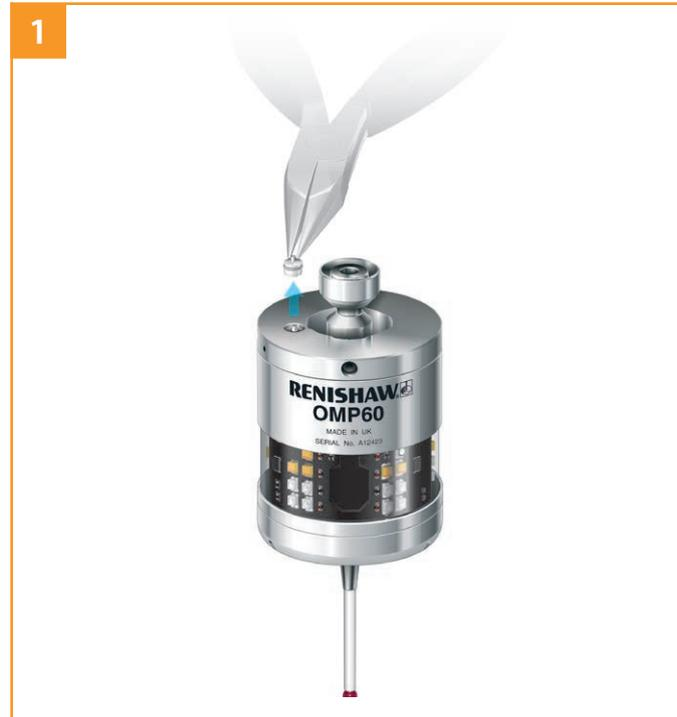
**注意:** OMP60 をシャンクスイッチで使用する際は、プローブ後方にあるプラグをプライヤー等で取り外す必要があります。そして代わりにボビン (A-4038-0303) を取り付けます。
