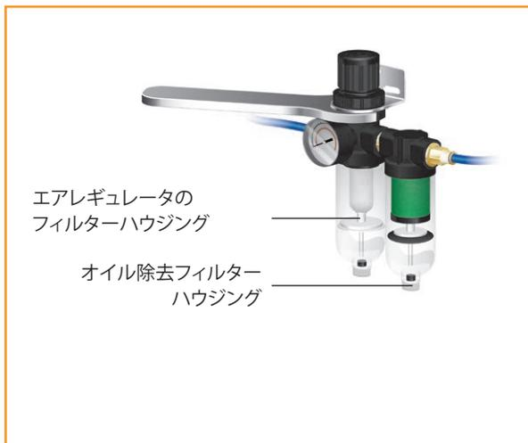
注：破線枠 A と B 内の部品は、レニショーの販売するエアフィルターサービスキットに含まれています (6.1 ページのパーツリストを参照してください)。
