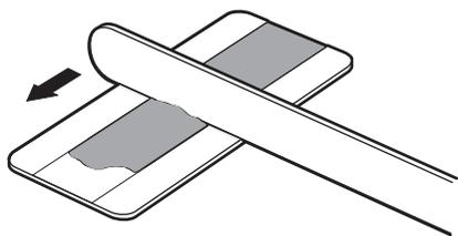
3. エンドクランプは 2 箇所両面にテープが付いています。このテープにより、エポキシ接着剤が硬化するまで、エンドクランプが所定に位置に仮固定されます。各両面テープの剥離紙をはがします。
