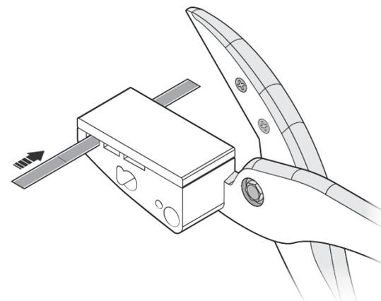
スケールを押さえながら、簡易裁断機をゆっくり閉じてスケールを切断します。
