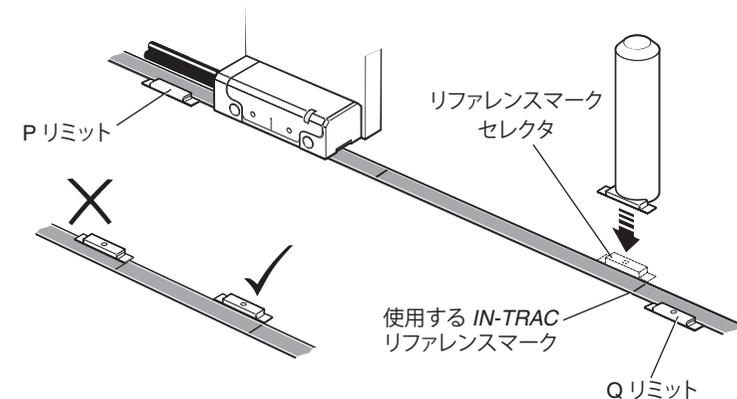
4. きれいな乾燥した不織布の上からリファレンスマークセクタ/リミットを手で押して、しっかりと貼り付けます。
