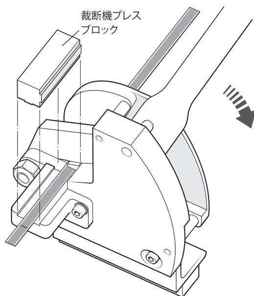
ブロックがずれないように押さえながら、レバーをゆっくり下に引いてスケールを切断します。
