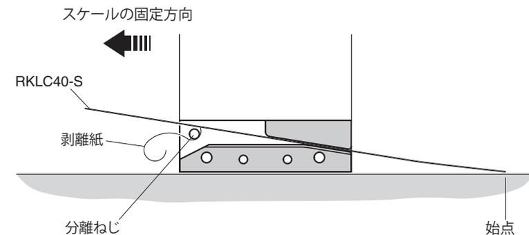
9. 取付け作業中、指で軽く押さえて、スケールを機材に貼り付かせます。
