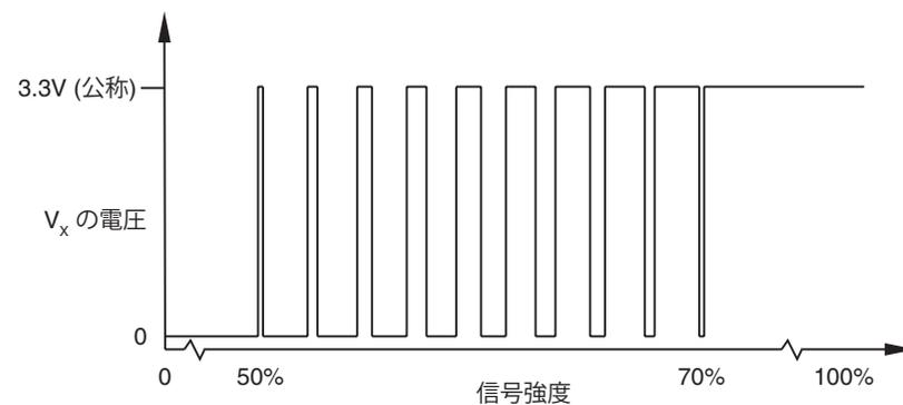
信号強度 50%~70% で、 $V_x$  はデューティサイクルです。3.3V の時間は、インクリメンタル信号強度に合わせて長くなります。信号強度が 70%を超える場合、 $V_x$  は公称 3.3V です。
