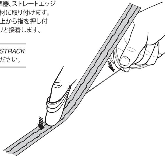
5. 中央セクション取外しツールを取り付け、前に動かして FASTRACK の中央セクションを外します。
