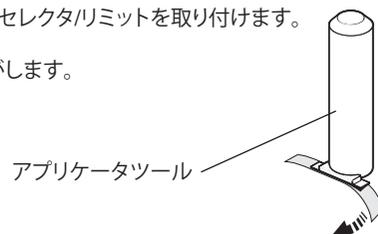
3. リファレンスマークセクタ/リミットを *FASTRACK* 上に配置します。この際、スケールの上には配置しないようにしてください。
