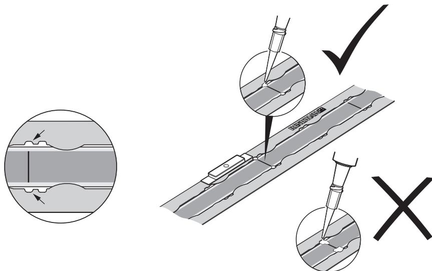
**注:** 確実に接着できるように、これらのギャップにのみ Loctite 435 を塗布してください。Loctite 435 がスケールの下で乾燥して、スケールを機材に固定します。
