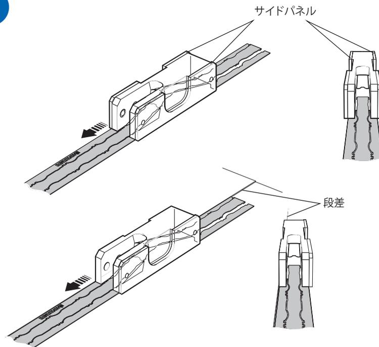
6. 下図のように、突起部の下に RTLC40 スケールを通して *FASTRACK* に挿入します。RTLC40 スケールは、*FASTRACK* の中を押したり引っ張ったりして配置します。または、下図のように RTL スケール挿入ツール (オプション) を使用すると便利です。
