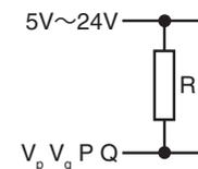
注: 抵抗 R を使用して、最大電流が 20mA を超えないようにしてください。または、適切なリレーまたは光アイソレータを使用してください。
