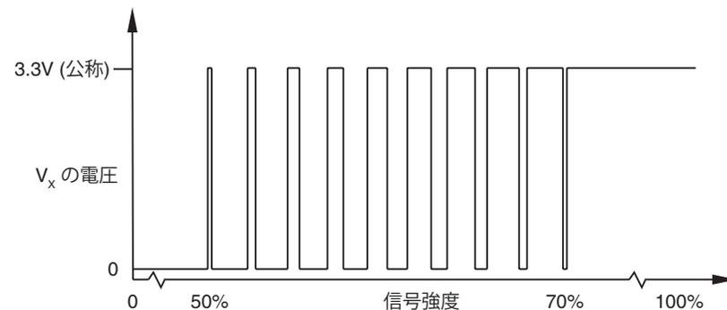
信号強度 50%~70% で、 $V_x$  はデューティサイクルです。3.3V の時間は、インクリメンタル信号強度に合わせて長くなります。信号強度が 70%を超える場合、 $V_x$  は公称 3.3V です。
