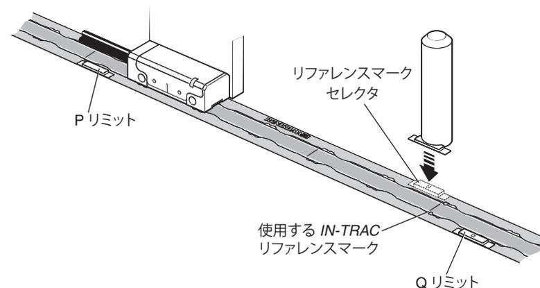
4. きれいな乾燥した不織布の上からリファレンスマークセクタ/リミットを手で押して、しっかりと貼り付けます。
