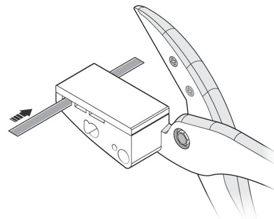
スケールを押さえながら、簡易裁断機をゆっくり閉じてスケールを切断します。
