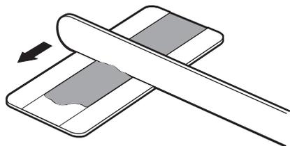
3. エンドクランプは 2 箇所両面にテープが付いています。このテープにより、エポキシ接着剤が硬化するまで、エンドクランプが所定位置に仮固定されます。各両面テープの剥離紙をはがします。
