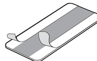
4. すぐに、エンドクランプをスケールの端に配置し、押し付けてしっかりと貼り付けます。完全に硬化させるには、20°C で 24 時間放置します。<sup>1</sup>
