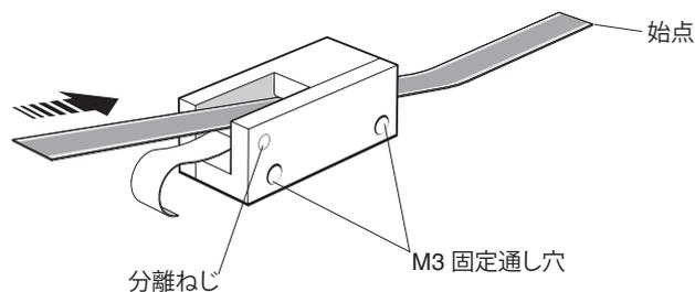
7. 乾いたきれいな不織布の上から指で強く押さえて、スケール端部を機材にしっかり接着します。
