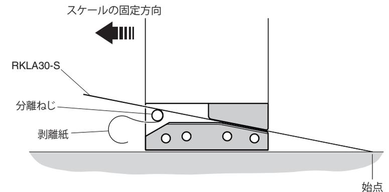
9. 取付け作業中、指で軽く押さえて、スケールを機材に貼り付かせます。
