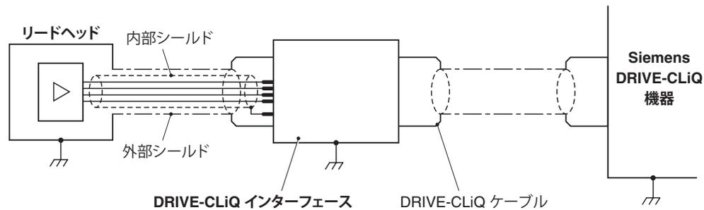
**重要:** ダブルシールドのリードヘッドケーブルを終端処理しない場合は、内部シールドと外部シールドは絶縁するようにしてください。内部シールドと外部シールドを接続すると、0V とアースがショートし、電気ノイズの問題が発生する場合があります。
