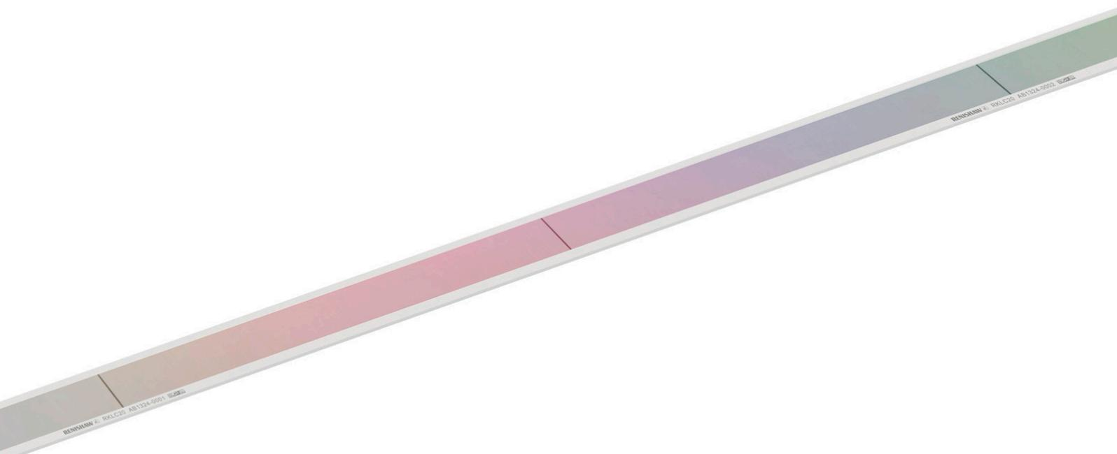
RKLC は幅 6mm の頑丈なステンレススチールテープスケールで、厚さは 0.15mm です。薄型であるため、機械軸にしっかりと固定することで、機材にマスタリングされ熱膨張率が同程度になります。そのため、スケールと機械の動きの差が小さくなり、シンプルな熱補正だけで測定性能が向上します。
