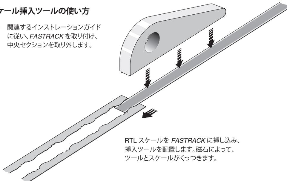
RTL スケールを *FASTRACK* に挿し込み、挿入ツールを配置します。磁石によって、ツールとスケールがくっつきます。
