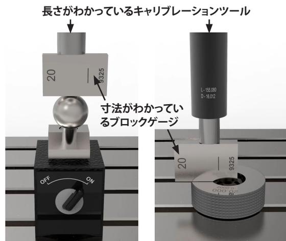
図 3: Z方向のワークオフセットの設定
