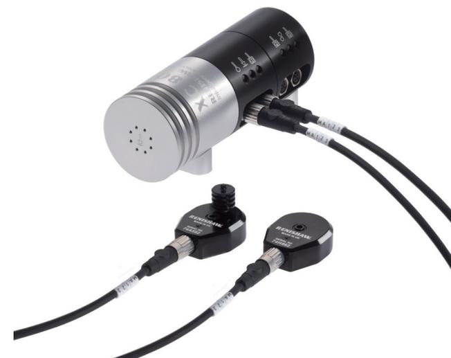
温度、気圧、相対湿度が変化すると、レーザービームの波長と計測値に影響が出ます。
