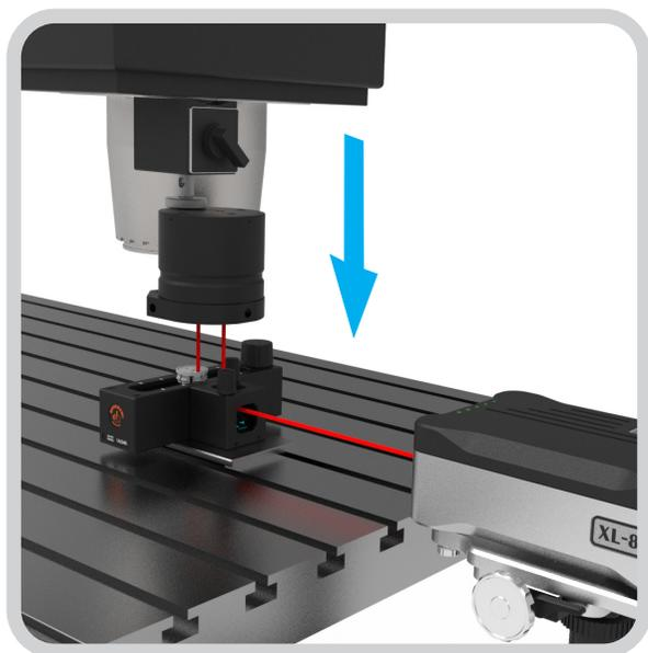
ストロークの上端でレーザービームを軸のターゲットの中央にアライメントしたら、主軸を真直度用ベースにできるだけ近づけます。
