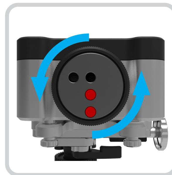
大きい方の照射口に合わせて 6mm のビームが照射されるよう、真直度用シャッタの黒いリングを回します。
