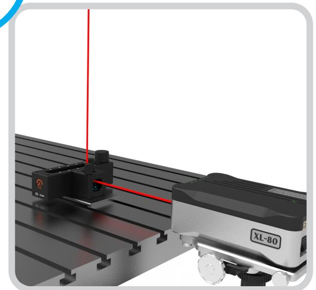
垂直真直度用ターニングミラーからターゲットキャップを取り外します。
