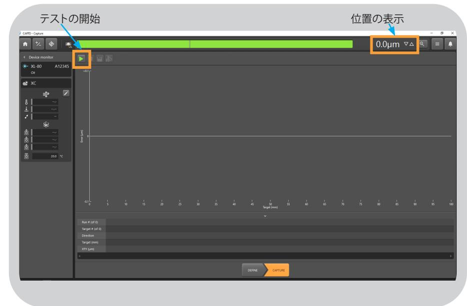
コントローラで適切なパートプログラムを選択し、機械でサイクルスタートを押して最初のターゲット位置まで機械を移動します。その後、機械はプログラム内の M00 コマンドで停止します。
