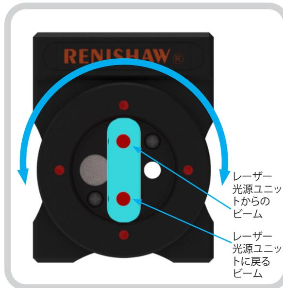
レーザービームが上側を通るよう、真直度干渉計のリングを回します。
