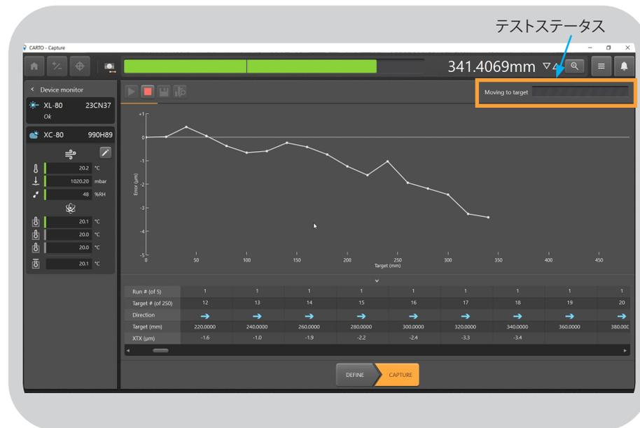
機械コントローラのサイクルスタートを押します。[トリガータイプ] を [位置] にしている場合は、データが自動的に収集されます。
