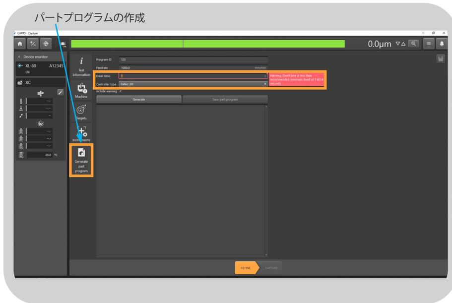
[パートプログラムの作成] タブでは、[装置] タブで設定した平均化処理をもとにドウェル時間が自動算出され、入力されています。
