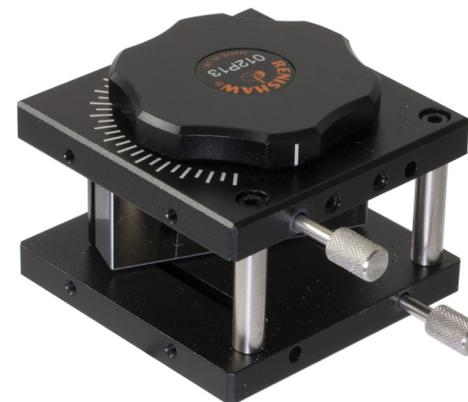
垂直面のレーザービームを 0°~135°の範囲で方向を変えたい場合に使用します。
