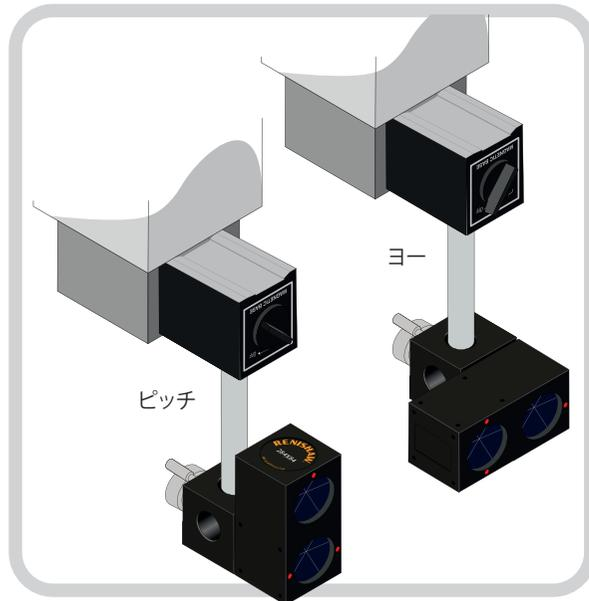
図のように反射鏡を組み付けます。機械の可動する部分に取り付けてください。
