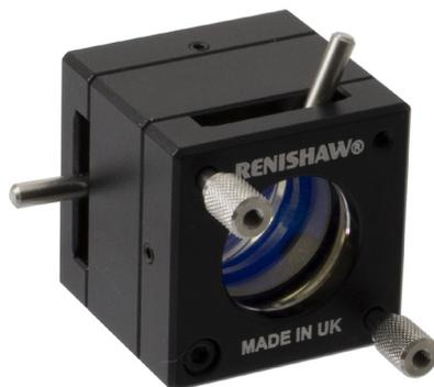
XL レーザーシステムのアライメントに使用します。レーザービームの垂直面および水平面の調整を簡単に行えます。また、三脚ステージ側でのレーザーユニットの調整量を減らすことができます。
