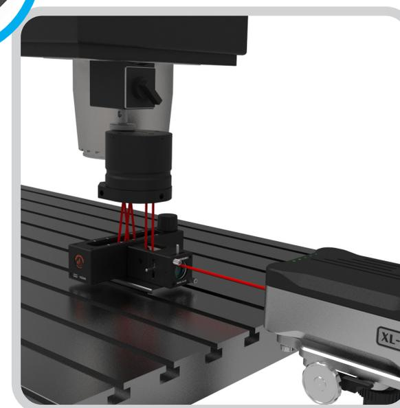
軸のフルストロークにわたってレーザービームが白いターゲットの中央からずれなくなるまで、先の3手順を繰り返します。
