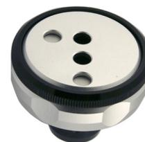
水平方向の真直度と垂直方向の真直度、両方の真直度計測に使用します。
