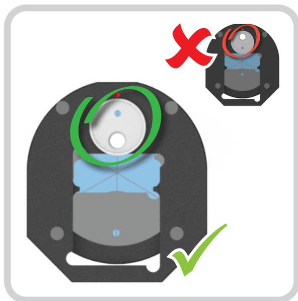
図示の向きで、大型反射鏡の開口部にターゲットキャップを取り付けます。
