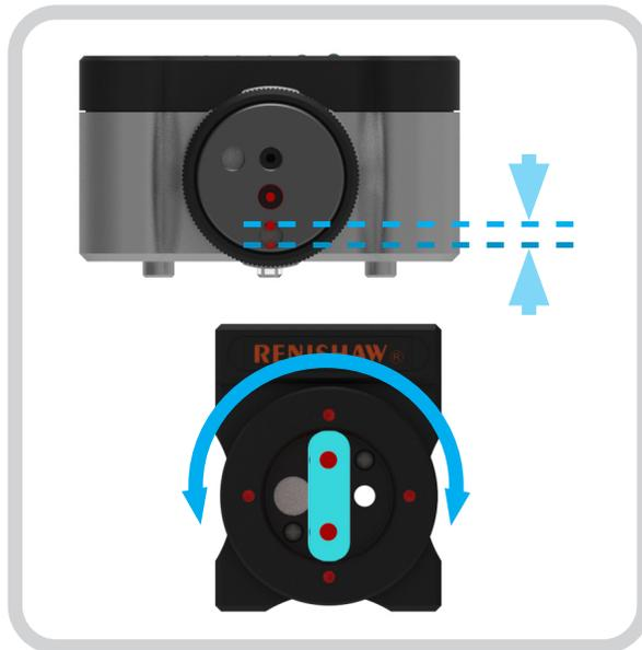
2本のビームが真直度用シャッタの表面で重なるよう、真直度干渉計のリングを回します。
