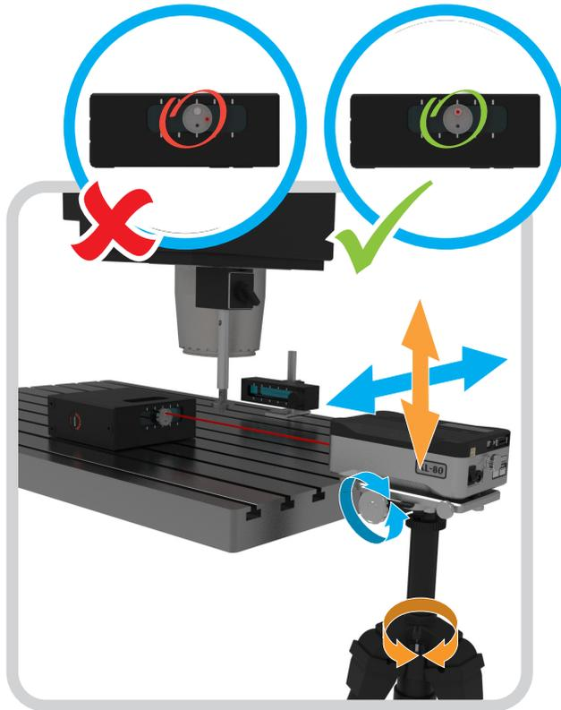
光学スクウェアに取り付けたターゲットキャップの白いターゲットの中心にビームが当たるよう、レーザー光源ユニットを平行移動して位置調整します。
