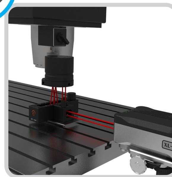
軸のフルストロークにわたってレーザービームが白いターゲットの中央からずれなくなるまで、先の3手順を繰り返します。
