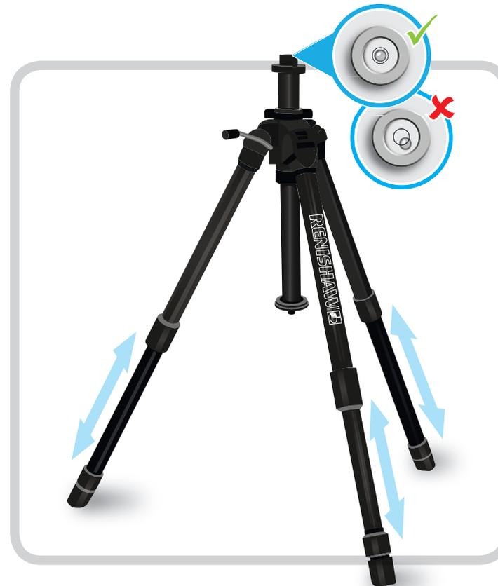
水平になるよう、三脚の脚を調整します。
