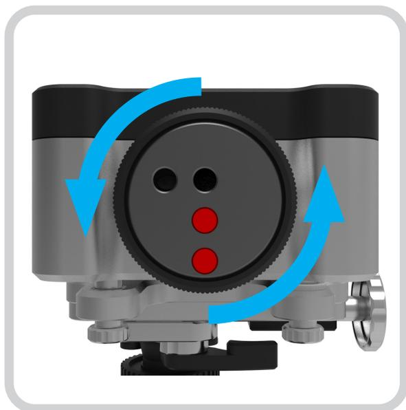
大きい方の照射口に合わせて、真直度用シャッタの黒いリングを回します。軸のフルストロークでの信号強度を確認します。
