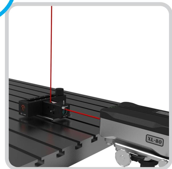
LS350 レーザーステアラからターゲットキャップを外します。
