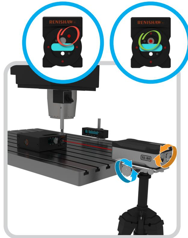
ビームが白いターゲットの中心に当たるよう、レーザー光源ユニットのピッチとヨーを調整します。
