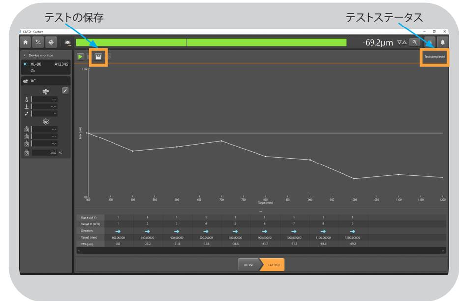
機械でサイクルスタートを再度押します。キーボードの F9 キーまたはマウスのホイールボタンを押してデータを以下の位置でデータを取得していきます。
