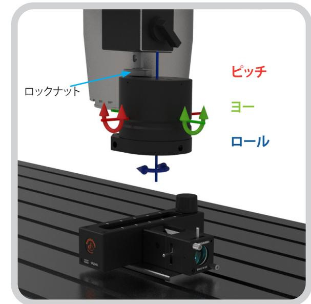
大型反射鏡が、機械のピッチ、ヨーおよびロールに対して直交しているか確認します。必要に応じて調整したら、回転してしまわないよう、M8 アダプタのロックナットを締めます。
