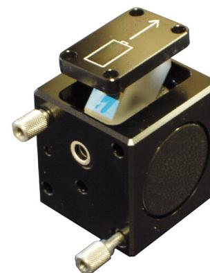
組み立てなおす際は、カートリッジをハウジングの長辺のいずれかにそろえてから、六角穴付きボルトを締めます。ハウジング内での光学部品のアライメントを確保するためです。
