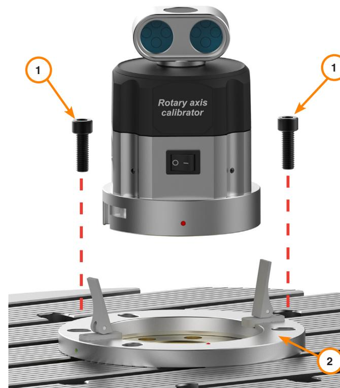
マウントリングは、ボルトを取付け穴を通して機械の T スロットにはめて、テーブルに固定します。
