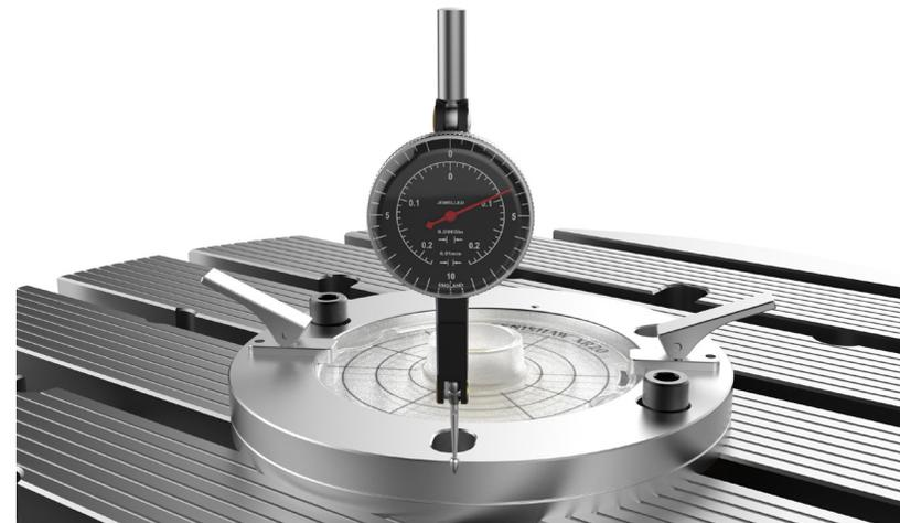
10. 位置合わせが完了したら、取付け穴を通して機械の T スロットにボルトをはめて、マウントリングを軸に固定します。T スロットが取付け穴の下に合わない場合は、トルクランプを使用しても問題ありません。センタリングエイドを取り外します。
