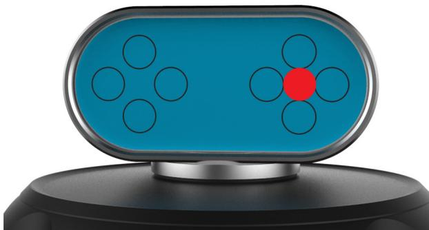
8. XL-80 を、下図のようにレーザービームがアライメントエイドのターゲットに当たるよう上下左右に平行移動させます。
