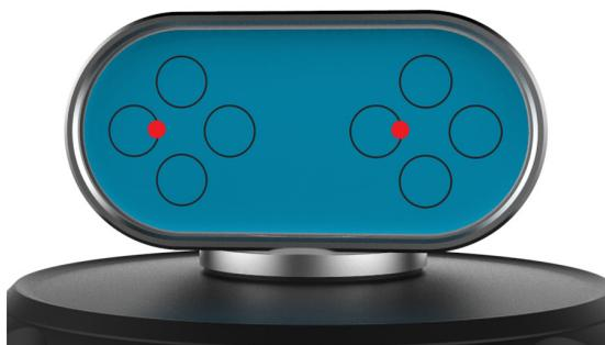
3. ビームブロッカに反射してくるビームを観察します。反射したビームがセンターラインにくるようにラUNCHユニットのピッチを調整します。
