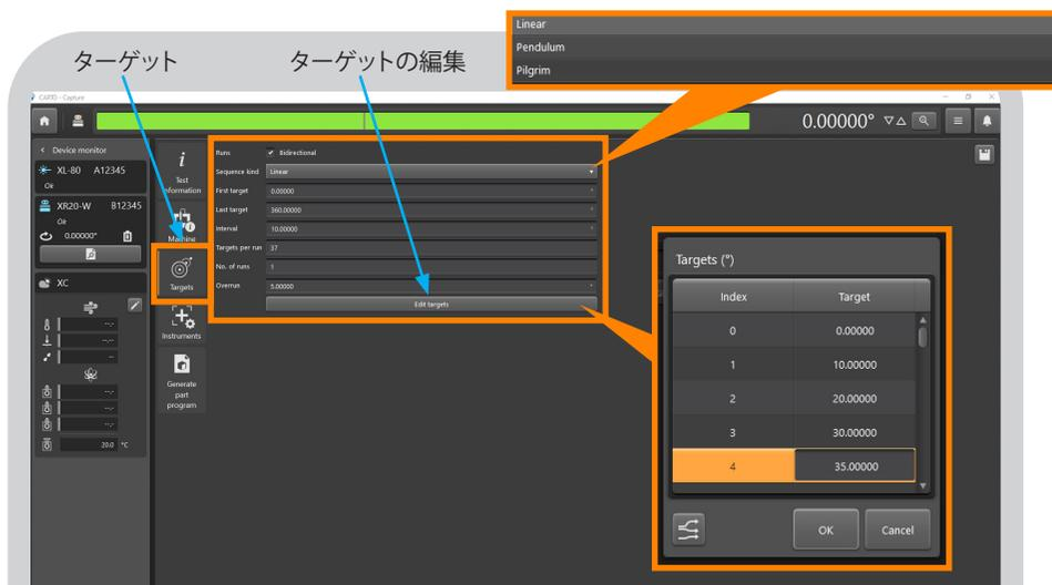
**二方向** - 各ターゲットを、プラス方向とマイナス方向から測定します。
