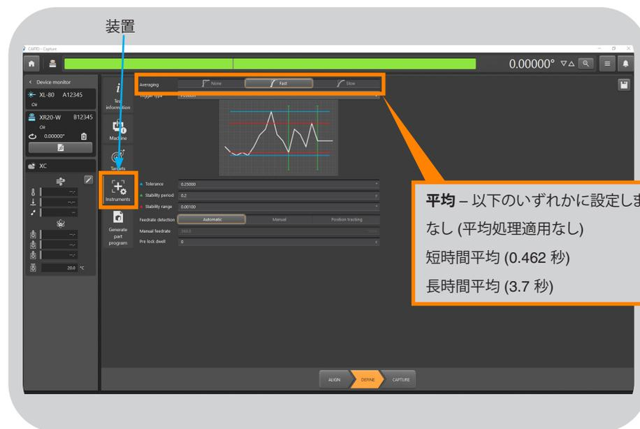
[装置] タブでは、平均化処理のタイプを選択します。
