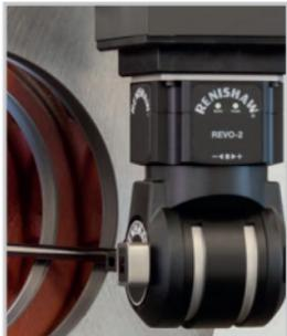
3차원 측정기(CMM)용 Renishaw 센서는 고유한 터치식 트리거 프로브, 모터 구동식 인덱싱 헤드, 반복 가능한 스타일러스 교환 및 모듈형 스캐닝 시스템 부문의 업계 표준입니다. Renishaw 5축 CMM 기술은 종래 기술에 내재된 속도 증가에 따른 정확도 저하 문제를 해결할 뿐 아니라 빠른 속도와 우수한 측정 유연성을 제공합니다.
