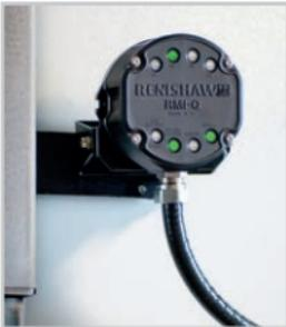
**RMI-Q 다중 프로빙**은 송수신기 결합형 인터페이스 장치로, 별도 Renishaw 무선 프로프를 최대 4개까지 개별적으로 시동 및 작동할 수 있습니다. RMI-Q를 사용하면 동일한 공장 기계에서 다수의 무선 프로브 및/또는 무선 공구 세팅기를 함께 사용할 수 있습니다. 옵티컬 전송 시스템과 달리 프로브와 수신기 사이에 가시선이 필요하지 않습니다.
