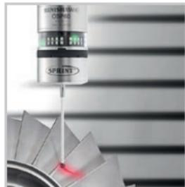
SPRINT 시스템은 부품 표면을 가로질러 정확한 3D 지점을 캡처하고 데이터를 실시간을 분석함으로써 자동화된 공정 내 제어 및 기계 생산력 검증 분야에 획기적인 변혁의 기회를 가져올 수 있습니다.
