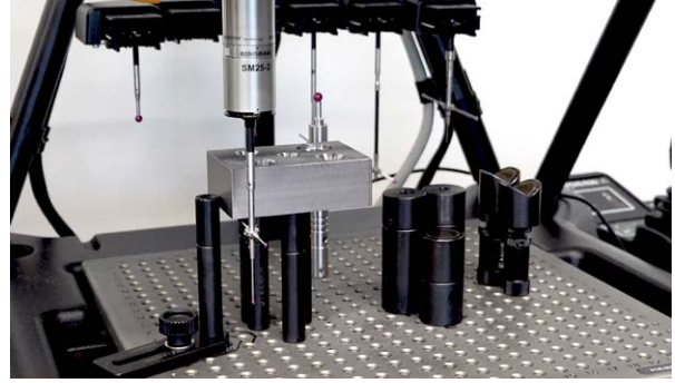
NIMS 가공 공작물을 검사하는 Renishaw Equator 측정 시스템
