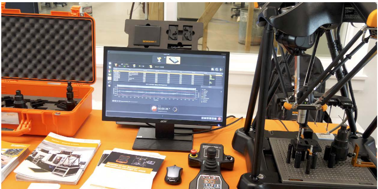
NIMS용 Equator 측정 패키지에는 사전 작성된 프로그램, 스타일러스, 계측 픽처 플레이트 2개, 13개 공작물을 모두 넣을 수 있는 픽처가 포함되어 있습니다. 사전 세팅된 프로그램, 스타일러스, 계측 픽처 플레이트 2개, 13개 공작물용 픽처로 구성된 NIMS용 Equator 측정 패키지
