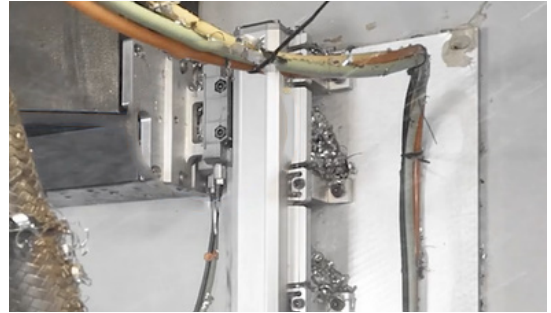
그림 3. 엔코더에서 에어 퍼지를 사용함으로써 극한 조건에서도 엔코더 압출부에 오염 물질이 들어가는 것을 방지합니다.
