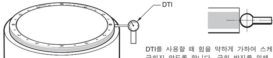
DTI를 사용할 때 힘을 약하게 가하여 스케일 표면이 굽히지 않도록 합니다. 굽힘 방지를 위해 루비 볼 스타일러스 장착형 DTI를 사용할 것을 권장합니다.
