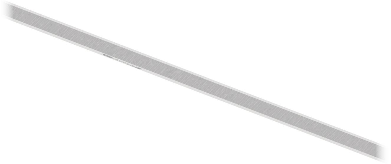
**RKLA30-S는 6 mm 너비, 0.15 mm 두께의 견고한 스테인리스 강철 엔코더 테이프 스케일입니다.** 따라서 기계 축에 단단히 고정되어 있는 스케일이 기계 모재의 열팽창 수축에 맞춰 '마스터링'될 수 있습니다. 그 결과 스케일과 기계 사이의 움직임 편차가 최소화되어 간단한 열 시스템 보정을 통해 계측 성능을 개선할 수 있습니다.
