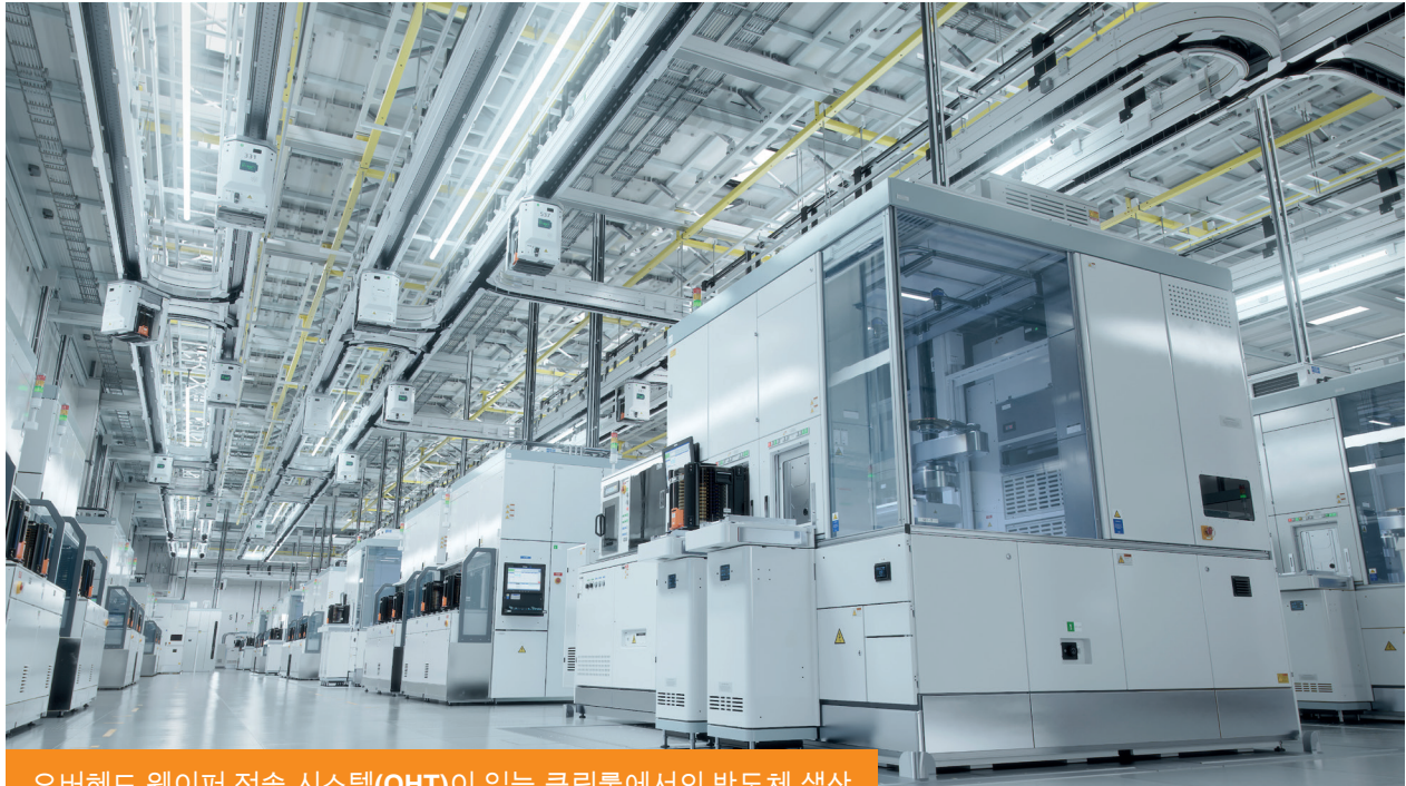
오버헤드 웨이퍼 전송 시스템(OHT)이 있는 클린룸에서의 반도체 생산
