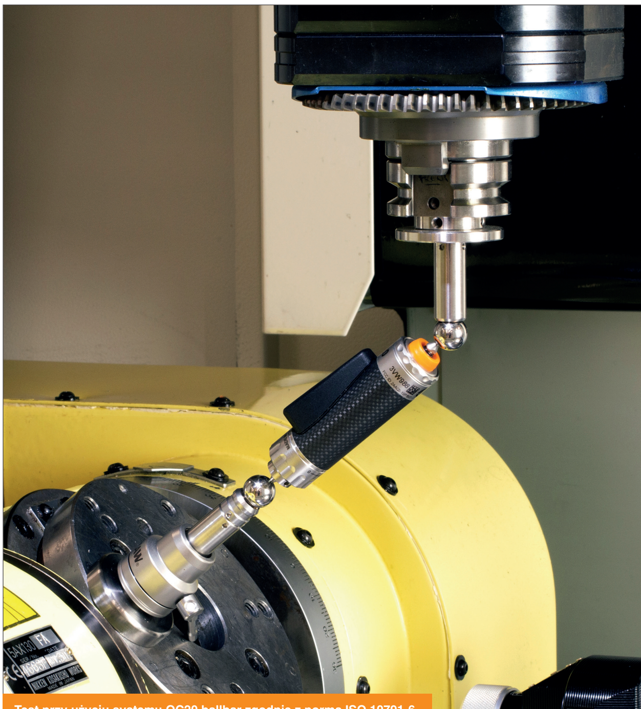
Test przy użyciu systemu QC20 ballbar zgodnie z normą ISO 10791-6
