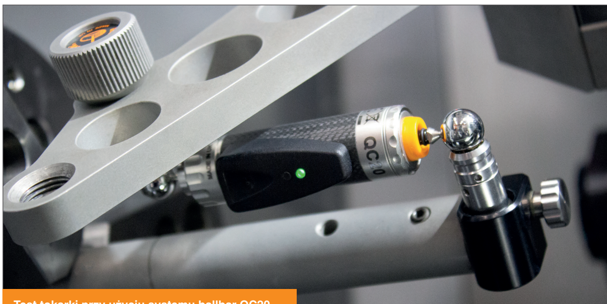
Test tokarki przy użyciu systemu ballbar QC20
