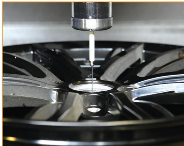
Sistema RMP60 – Medição da superfície de montagem das rodas
