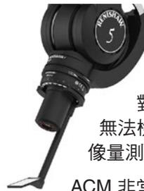
ACM 非常適合汽車業應用，因為可用於檢測難以接近的發動機氣缸孔表面和電動馬達定子的特徵。
