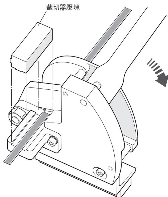
在固定壓塊時，以流暢動作拉下控制桿來裁切光學尺。
