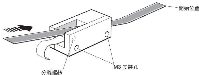
7. 用手指透過乾淨的無棉絮乾布施加壓力，以確保光學尺末端確實貼附於基材上。
