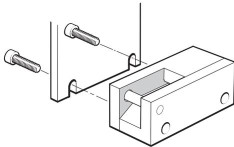
附註：光學尺安裝工具可以採用任一方向安裝，以便在安裝光學尺時找到最方便安裝的方向。
