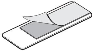
2. 將端點貼片邊緣上的記號對齊光學尺的末端，然後將端點貼片置於光學尺上。
