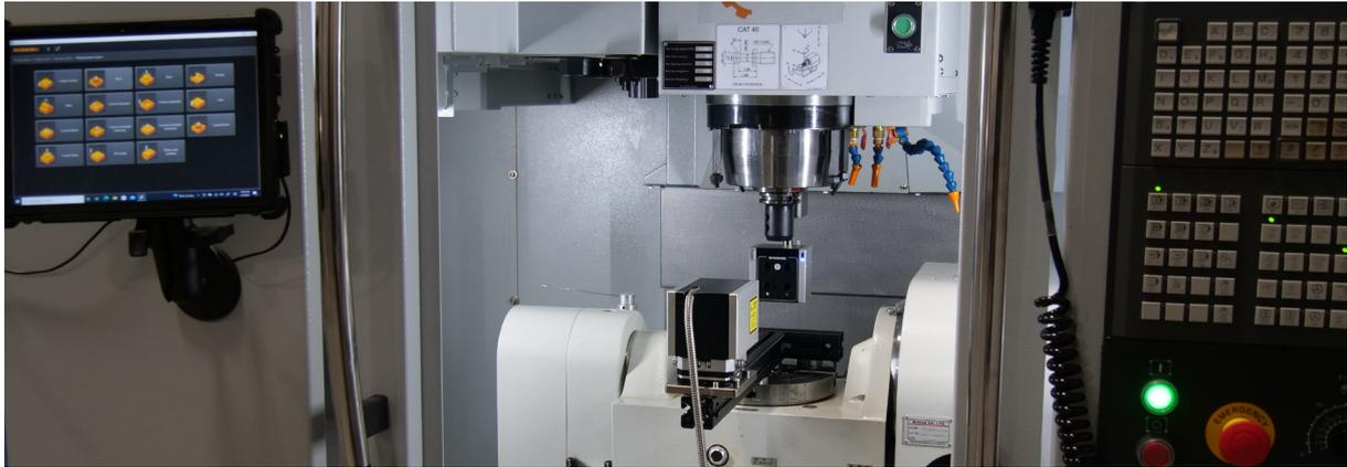
KES 在 CNC 工具機和 CMM 上使用 XM-60 多光束校正儀執行空間補償
