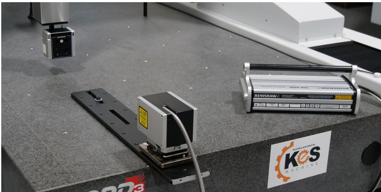
Renishaw XM-600 多光束校正儀在 CMM 上執行測試
