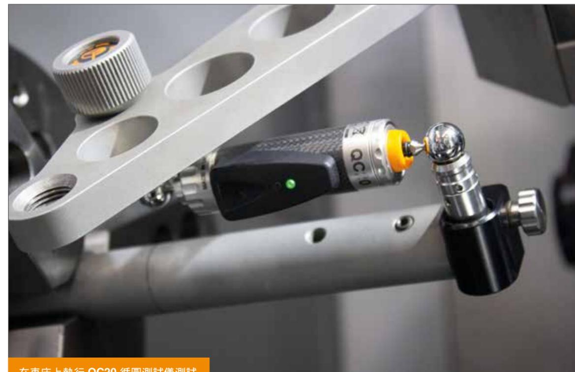
在車床上執行 QC20 循圓測試儀測試
